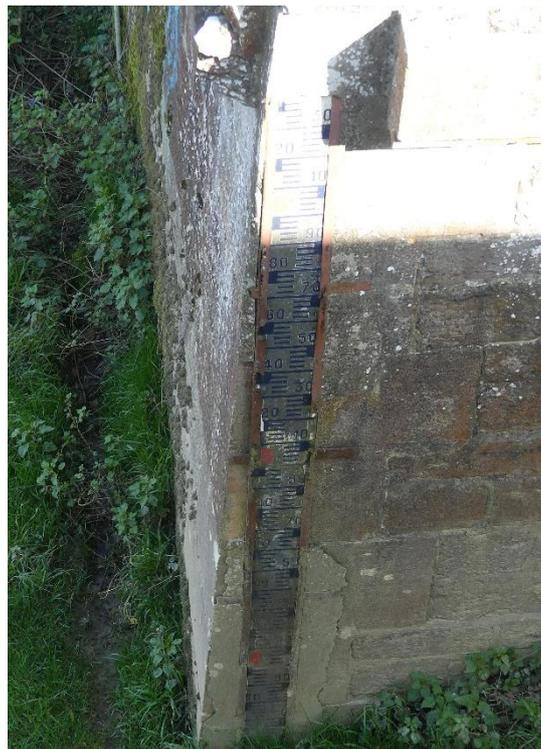
**Figure 23 : exemple d'échelle en place, peu visible**
