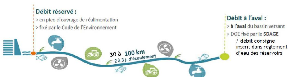
Figure 112 : Schématisation des variables entre les réservoirs de soutien d'étiage et le débit de référence
