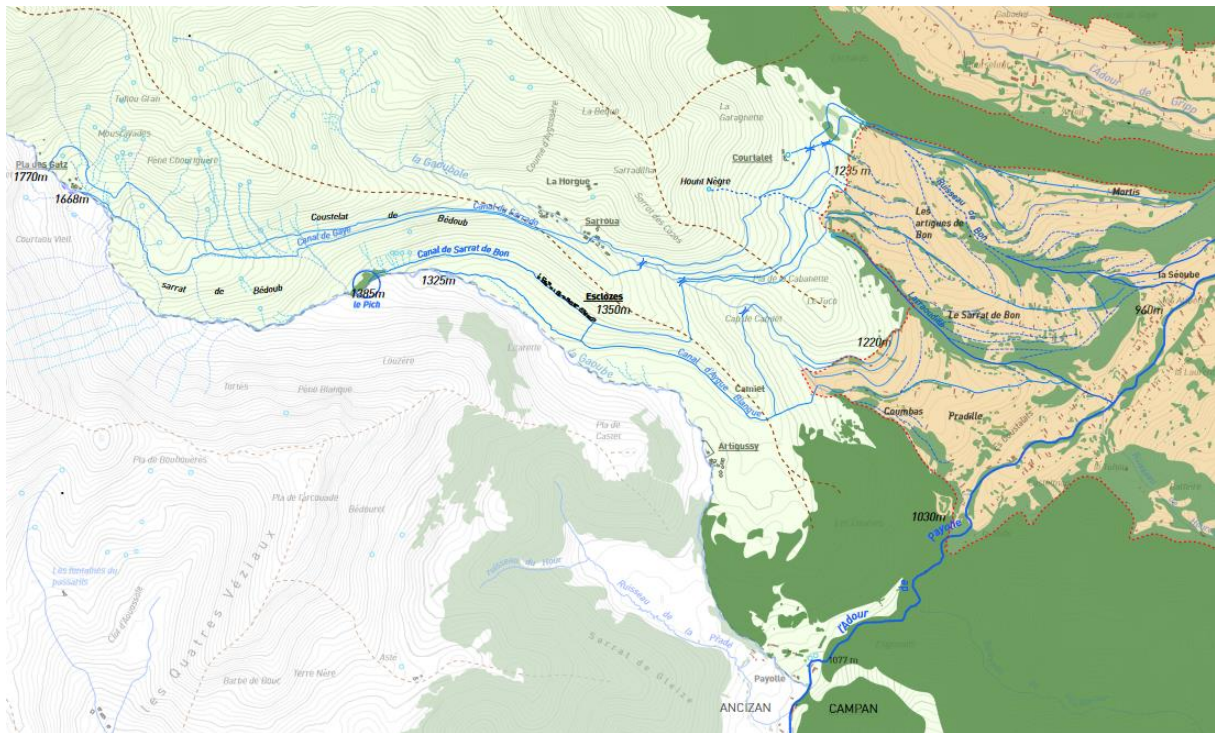
Figure 4 : Exemple de réseaux de rigoles dans la vallée de Campan
