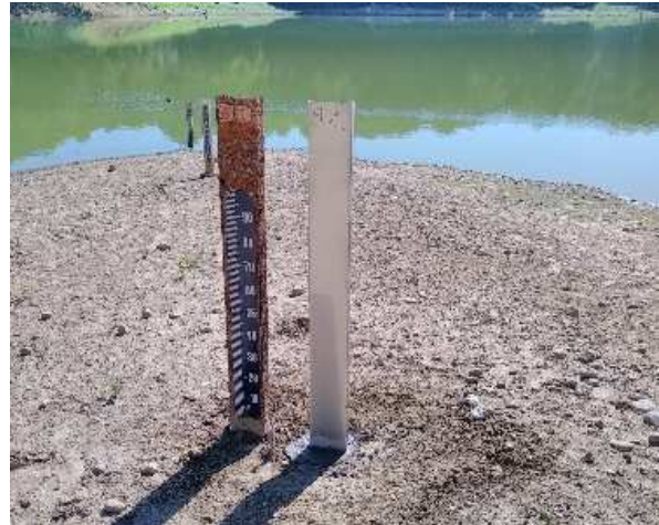
Figure 28 : Maintenance des échelles limnimétriques en septembre
