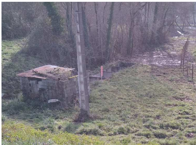
Figure 40 : Vue sur le local technique dégradé et sur les bassins sans protection antichute
