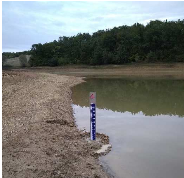
Figure 1 : Echelles limnimétriques après remplacement
