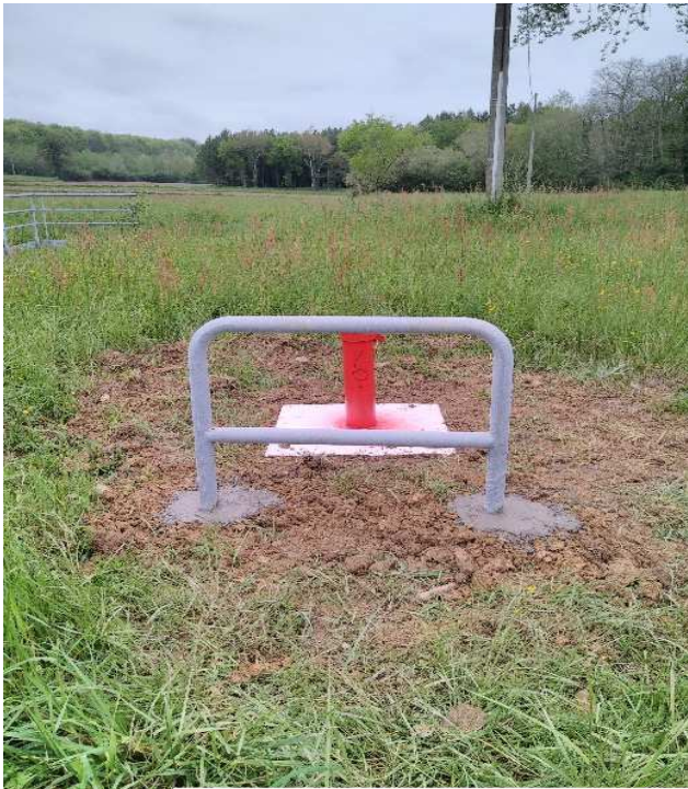
Figure 19 : Piézomètres après réparations
