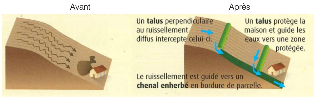
Figure 13 : Exemple de cas pour un aménagement de type fossé-talus (source AREAS)
